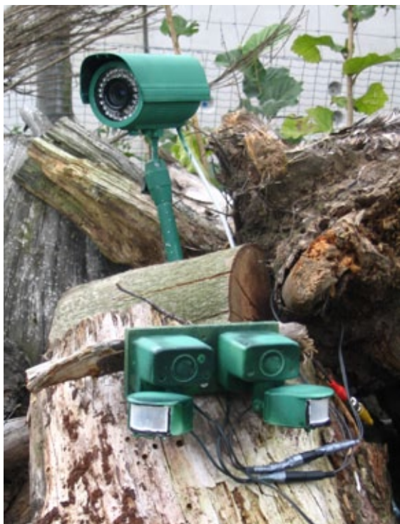
Figuur 6.24 Eén van de camera's op ecoduct De Borkeld en twee infrarood-bewegingsmelders.
