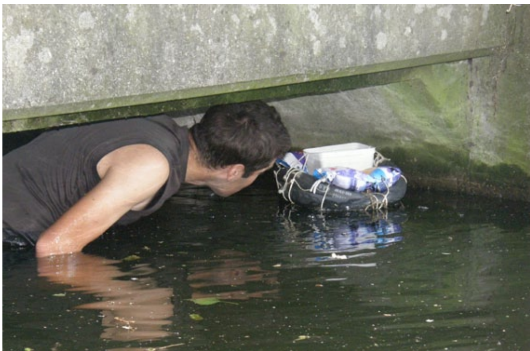
Figuur 6.29 Het plaatsen van een Anabat op een vlotje in een duiker (foto: Dimitri Emond/BuWa).
