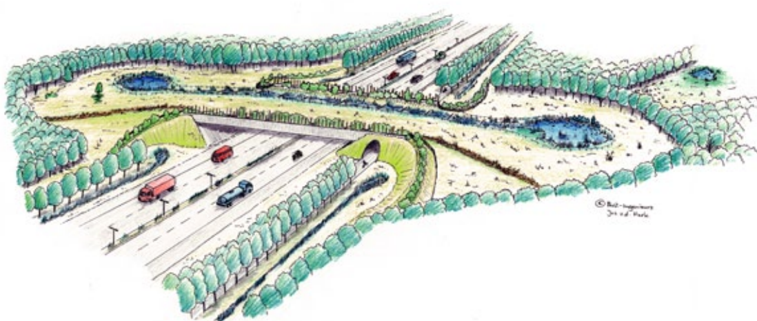
Figuur 8.16 Ecoduct 'Het Groene Woud' over de A2 ten zuiden van 's Hertogenbosch. Hier wordt met een pomp water boven op het ecoduct gebracht, dat via een systeem van kleine poeltjes (wadi's) naar de twee grote poelen aan weerszijden van het ecoduct stroomt. Zo ontstaat een natte verbinding voor amfibieën, waaronder de doelsoort kamsalamander (Tekening: Jos van de Hurk, BWZ-ingenieurs).
